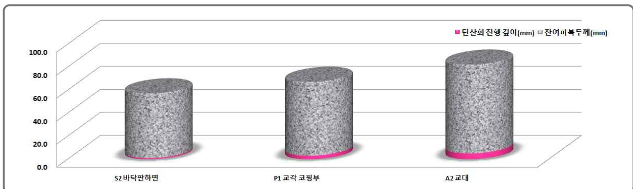
[그림 13.3.7] 탄산화깊이 및 잔여피복두께 측정결과
