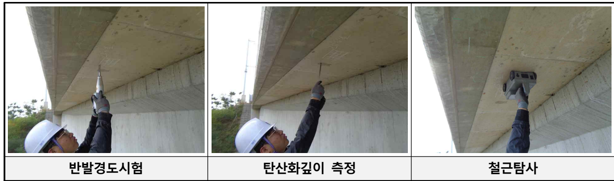
[그림 13.3.1] 비파괴시험 수행 사진
